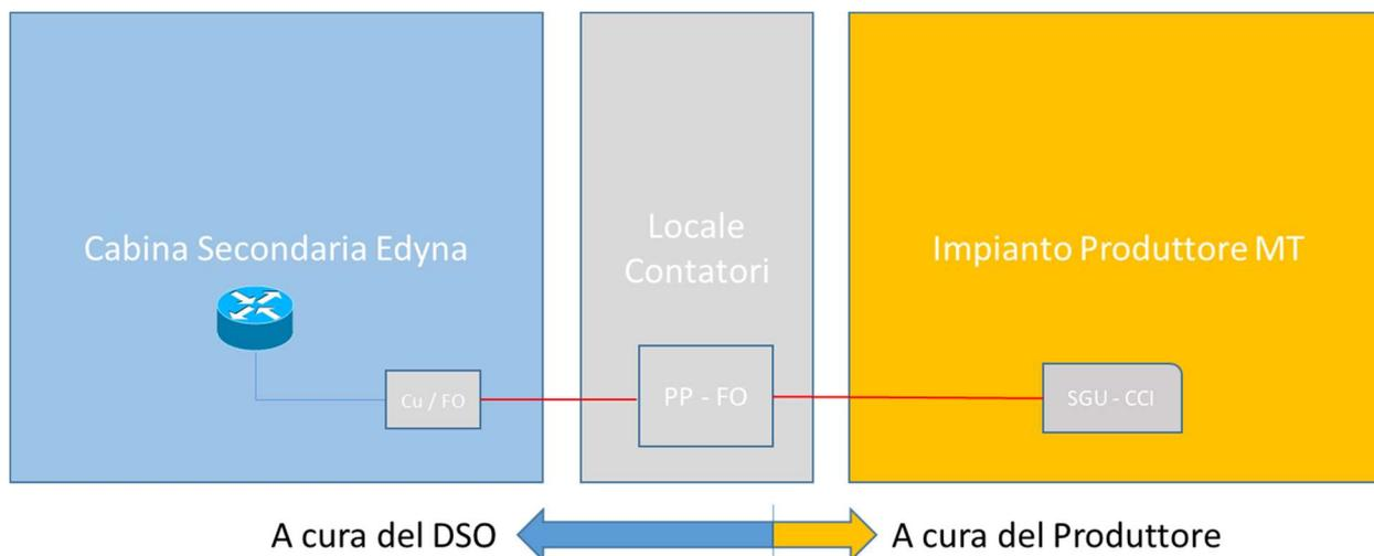
La tipologia della fibra ottica utilizzata dev'essere compatibile con la porta ottica del CCI lato DSO indicata dalla Norma CEI 0-16, Allegato O, paragrafo O.13.1.1. ed in particolare:
